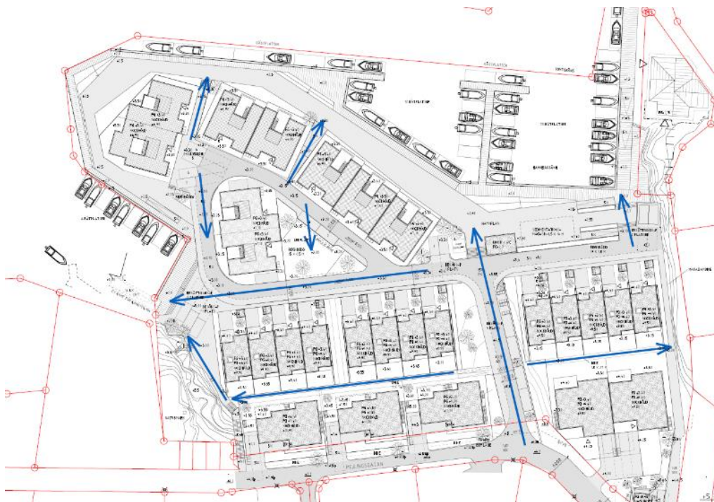
Figur 17. Karta visandes föreslagen höjdsättning av marken och färdigt golv i byggnader samt vattnets avrinningsriktningar (blå pilar).
