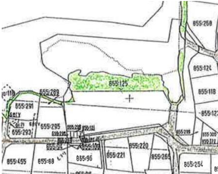
Figur 21 Utklipp från bilaga V från akt 1480K-2001F176 gällande fastighetsbestämning av servitut. Brun färg avser väg och grön färg avser anläggandet av brygga mm, för mer detaljerad beskrivning se akt förrättningsakt 1480K-2001F176. Prickad linje markerar ungefärlig nuvarande strandlinje.
